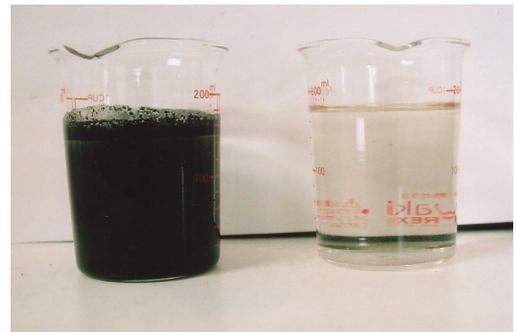
次の写真は有機性排水を浄化したもので、右が微粒分造粒品を入れたもので徐々に吸着され細菌が有機物を分解し浄化が行われ、透明度が増し水質が保たれます。
